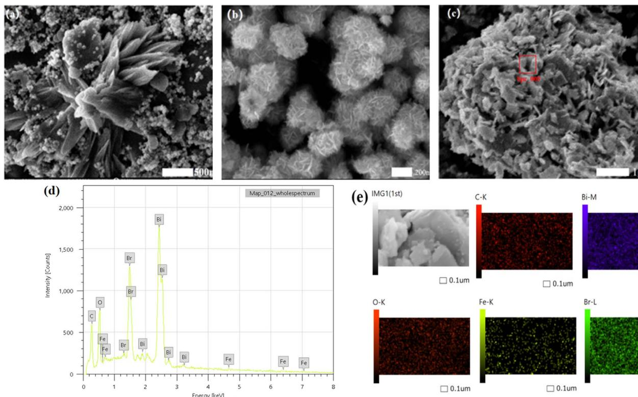
Fig. 2 SEM (a)  $\alpha$ - $\text{Fe}_2\text{O}_3$ ; (b) BiOBr; (c) BiOBr/ $\alpha$ - $\text{Fe}_2\text{O}_3$ ; (d) BiOBr/ $\alpha$ - $\text{Fe}_2\text{O}_3$  EDS; (e) BiOBr/ $\alpha$ - $\text{Fe}_2\text{O}_3$  mapping.
