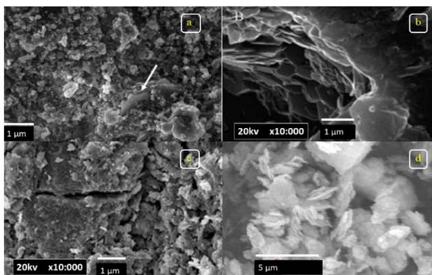
Fig. 17 (a)–(d) SEM images obtained for metakaolin geopolymers.<sup>97–99</sup>
