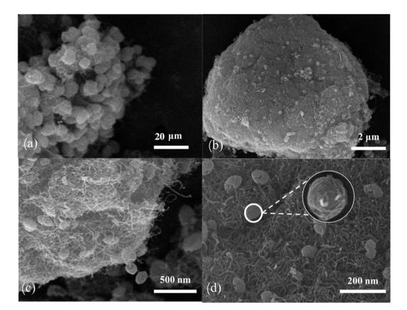
Fig. 2 The SEM of Zn/Co-ZIF@CNTs (a) 20  $\mu$ m, (b) 2  $\mu$ m, (c) 500 nm, (d) 200 nm.
