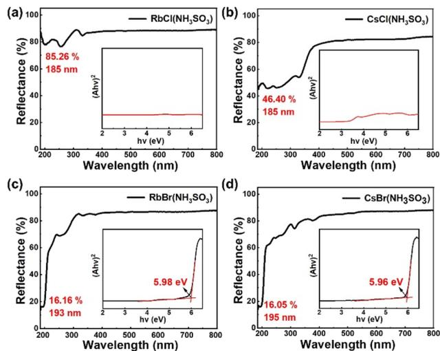
Fig. 2 UV-vis diffuse reflectance spectra of (a)  $\text{RbCl}(\text{NH}_3\text{SO}_3)$ , (b)  $\text{CsCl}(\text{NH}_3\text{SO}_3)$ , (c)  $\text{RbBr}(\text{NH}_3\text{SO}_3)$ , and (d)  $\text{CsBr}(\text{NH}_3\text{SO}_3)$ .
