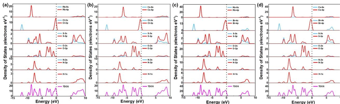
Fig. 3 Total and partial DOS of (a)  $\text{RbCl}(\text{NH}_3\text{SO}_3)$ , (b)  $\text{CsCl}(\text{NH}_3\text{SO}_3)$ , (c)  $\text{RbBr}(\text{NH}_3\text{SO}_3)$ , and (d)  $\text{CsBr}(\text{NH}_3\text{SO}_3)$ .
