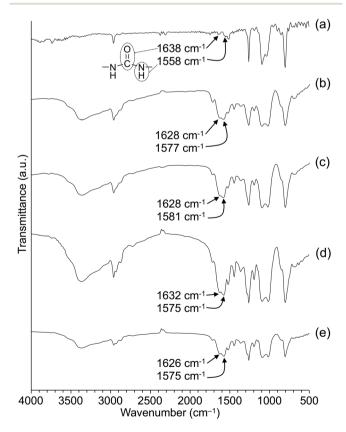
Fig. 1 FT-IR spectra of PDMS-PS-Ph(OH)<sub>2</sub> (x:y) in KBr pellets; x:y=(a) 9:1, (b) 8:2, (c) 7:3, (d) 6:4 and (e) 5:5.
