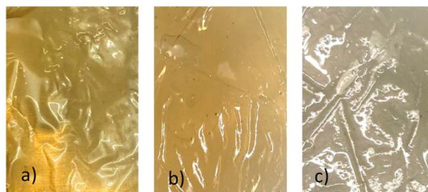
**Fig. 11** Photographs of three different blend membranes with Ter-Phos (a) p-PSU<sub>a</sub> : Ter-Phos, 1 : 1; (b) p-PSU<sub>b</sub> : Ter-Phos, 1 : 1; (c) p-PSU<sub>s</sub> : Ter-Phos, 1 : 1.
