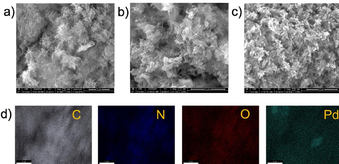
Fig. 3 (a–c) FE-SEM images of Pd@COF-TFP\_TzPy. (d) EDX mapping of Pd@COF-TFP\_TzPy.
