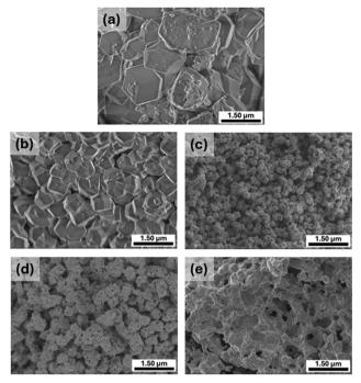
Fig. 4 SEM images of (a) Fe-ZIF-8, (b) Fe-ZIF-8 300, (c) Fe-ZIF-8 500, (d) Fe-ZIF-8 700, and (e) Fe-ZIF-8 900 at 20 000× magnification.
