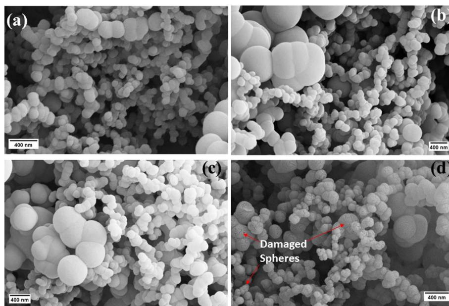
Fig. 1 SEM micrographs of (a) pristine SCS, (b) SCS-B<sup>+</sup>, (c) SCS-N<sup>+</sup>, and (d) SCS-Ne<sup>+</sup> samples after 7 h implantation time.
