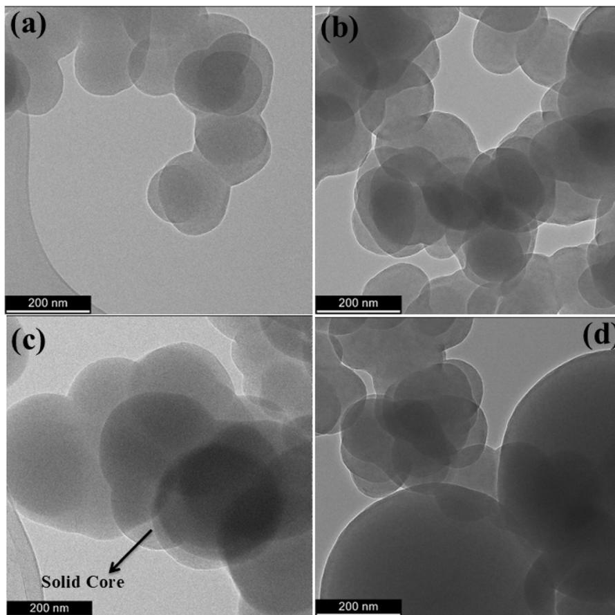
Fig. 2 TEM images of (a) pristine SCS, (b) SCS-B<sup>+</sup>, (c) SCS-N<sup>+</sup>, and (d) SCS-Ne<sup>+</sup> samples after 7 h implantation time.
