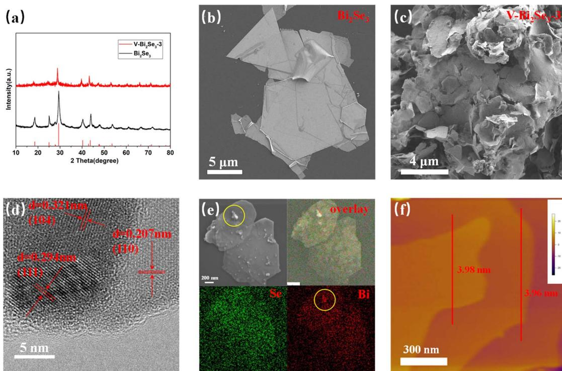
Fig. 1 (a) XRD spectra of  $\text{Bi}_2\text{Se}_3$  and  $\text{V-Bi}_2\text{Se}_3\text{-3}$ ; (b and c) SEM images of  $\text{Bi}_2\text{Se}_3$  and  $\text{V-Bi}_2\text{Se}_3\text{-3}$ ; (d) TEM images of  $\text{V-Bi}_2\text{Se}_3\text{-3}$ ; (e) EDS mapping images of  $\text{V-Bi}_2\text{Se}_3\text{-3}$ ; (f) AFM images of  $\text{V-Bi}_2\text{Se}_3\text{-3}$ .
