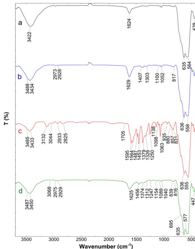
Fig. 1 FT-IR analysis of (a)  $\text{Fe}_3\text{O}_4$ , (b)  $\text{Fe}_3\text{O}_4@\text{Gly}$  (c)  $\text{Fe}_3\text{O}_4@\text{salicylamide}$  and (d)  $[\text{Fe}_3\text{O}_4@\text{salicylamide-L-proline-Ni(II)}]$  nanocomposite.
