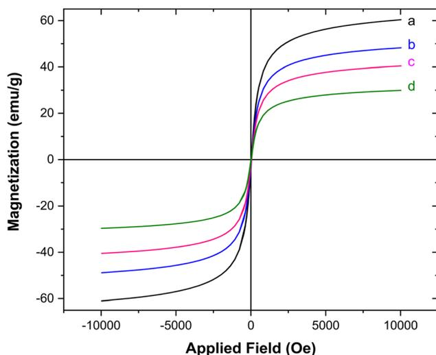
Fig. 8 VSM analysis of (a)  $\text{Fe}_3\text{O}_4$ , (b)  $\text{Fe}_3\text{O}_4@\text{Gly}$ , (c)  $\text{Fe}_3\text{O}_4@\text{salicylamide}$  and (d)  $[\text{Fe}_3\text{O}_4@\text{salicylamide-L-proline-Ni(II)}]$  nanocomposite.
