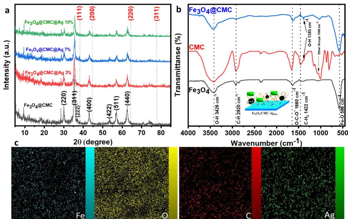
Fig. 1 (a) XRD patterns of  $\text{Fe}_3\text{O}_4/\text{CMC}$ ,  $\text{Fe}_3\text{O}_4/\text{CMC}-\text{Ag}-3\%$ ,  $\text{Fe}_3\text{O}_4/\text{CMC}-\text{Ag}-7\%$  and  $\text{Fe}_3\text{O}_4/\text{CMC}-\text{Ag}-10\%$ . (b) FT-IR spectra of  $\text{Fe}_3\text{O}_4$ , CMC and  $\text{Fe}_3\text{O}_4/\text{CMC}$ . (c and d) EDX mapping image of  $\text{Fe}_3\text{O}_4/\text{CMC}-\text{Ag}-7\%$ .
