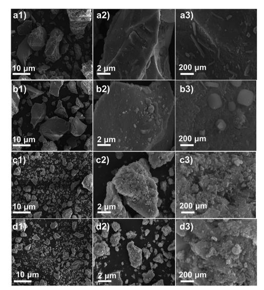
Fig. 2 SEM images of UDH (a1)-(a3), ZDH1 (b1)-(b3), ZDH4 (c1)-(c3), and ZDH7 (d1)-(d3) samples at various magnifications.
