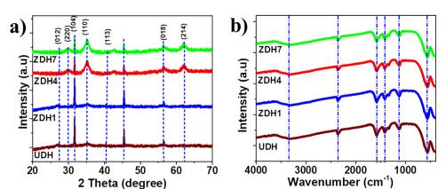
XRD patterns (a) and FTIR spectra (b) of the UDH, ZDH1, ZDH4, and ZDH7 samples
