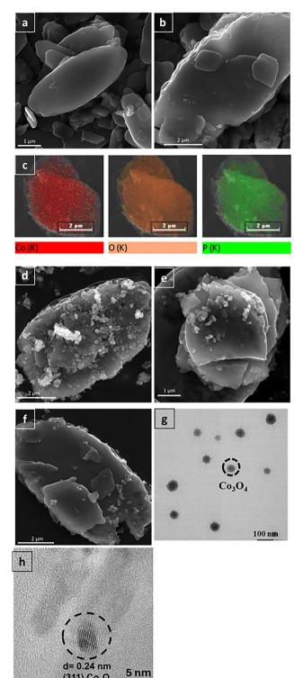
Fig. 2 SEM images of (a)  $Co_3(PO_4)_2$ , (b) amorphous  $Co_3(PO_4)_2$ , (d)  $Co_3(PO_4)_2$ @10%  $Co_3O_4$ , (e)  $Co_3(PO_4)_2$ @5%  $Co_3O_4$  and (f)  $Co_3(PO_4)_2$ @1%  $Co_3O_4$ . (c) EDX Mapping of  $Co_3(PO_4)_2$  and (g) and (h) HR-TEM of Co<sub>3</sub>(PO<sub>4</sub>)<sub>2</sub>@1% Co<sub>3</sub>O<sub>4</sub>.
