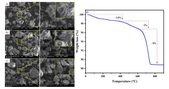
Fig. 3 SEM images of NC (a), AC (b), and AC-750 °C (c); TGA (d) of NC.
