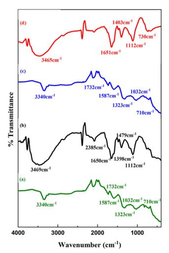
Fig. 2 FT-IR spectrum of (a) Ag NPs, (b) rGO, (c) Ag@rGO, and (d) Ag@rGO/CNT.
