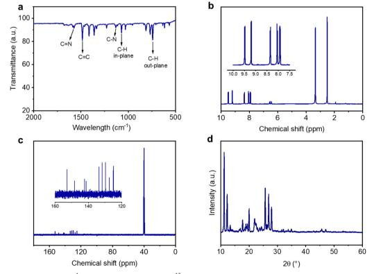
Fig. 1 (a) FT-IR spectrum of DPPZ. (b) <sup>1</sup>H NMR spectrum of DPPZ. (c) <sup>13</sup>C NMR spectrum of DPPZ. (d) The XRD pattern of DPPZ.
