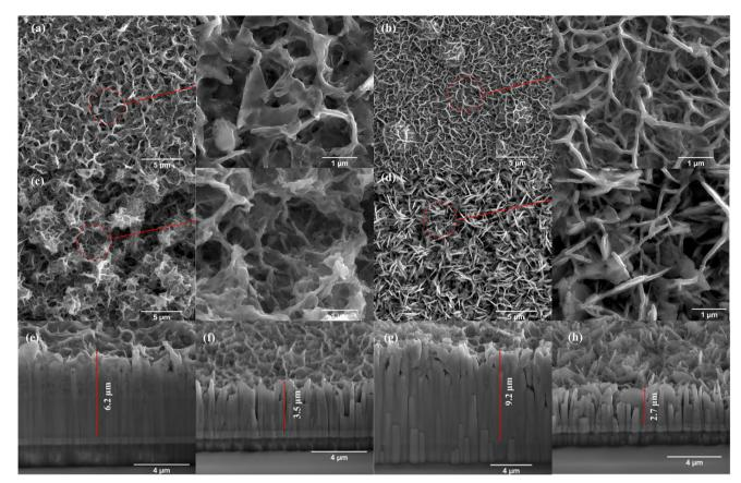
Fig. 4 Top-view SEM image at low and high magnifications of prepared indium sulfide thin films: (a) LC-IS-3, (b) LC-IS-10, (c) LCHCI-IS-3, and (d) LCHCI-IS-10. Cross-sectional SEM images: (e) LC-IS-3, (f) LC-IS-10, (g) LCHCI-IS-3, (h) LCHCI-IS-10.
