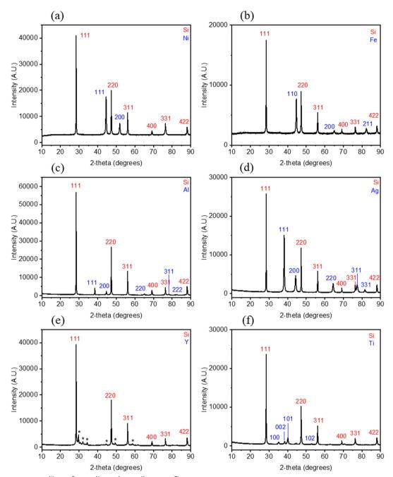
Fig. 3 XRD patterns of a) Si<sup>Ni</sup>, b) Si<sup>Fe</sup>, c) Si<sup>Al</sup>, d) Si<sup>Ag</sup>, e) Si<sup>Y</sup>, and f) Si<sup>Ti</sup> (\* Y peaks).
