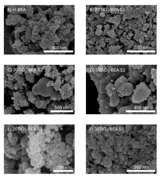
Fig. 5 SEM images of the different composites: A) H-BEA, B) 20TiO<sub>2</sub>-BEA S2, C) 30TiO<sub>2</sub>-BEA S2, D) 50TiO<sub>2</sub>-BEA S2, E) 20TiO<sub>2</sub>-BEA S1 and F) 30TiO2-BEA S1 samples.
