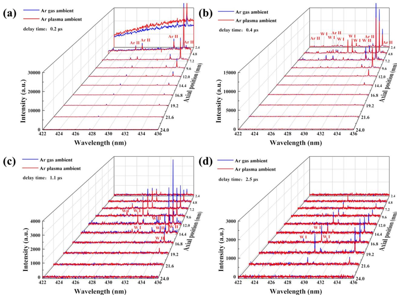
Fig. 6 Comparison of the spatio-temporal evolution of W plasma spectra under Ar gas ambient and Ar plasma ambient. Delay time: (a) 0.2  $\mu\text{s}$ ; (b) 0.4  $\mu\text{s}$ ; (c) 1.0  $\mu\text{s}$ ; (d) 2.5  $\mu\text{s}$ .
