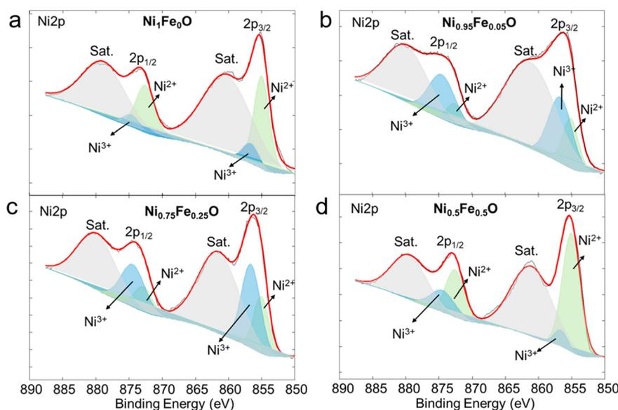
Fig. 3 XPS spectra of Ni 2p for (a) Ni<sub>1</sub>Fe<sub>0</sub>O, (b) Ni<sub>0.95</sub>Fe<sub>0.05</sub>O, (c) Ni<sub>0.75</sub>Fe<sub>0.25</sub>O, and (d) Ni<sub>0.5</sub>Fe<sub>0.5</sub>O ECs.
