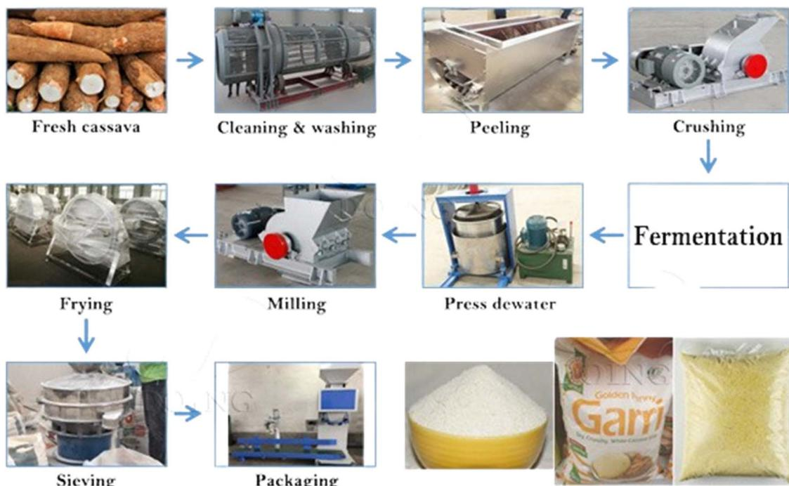
Fig. 4 Mechanised gari production process diagram.<sup>125</sup>
