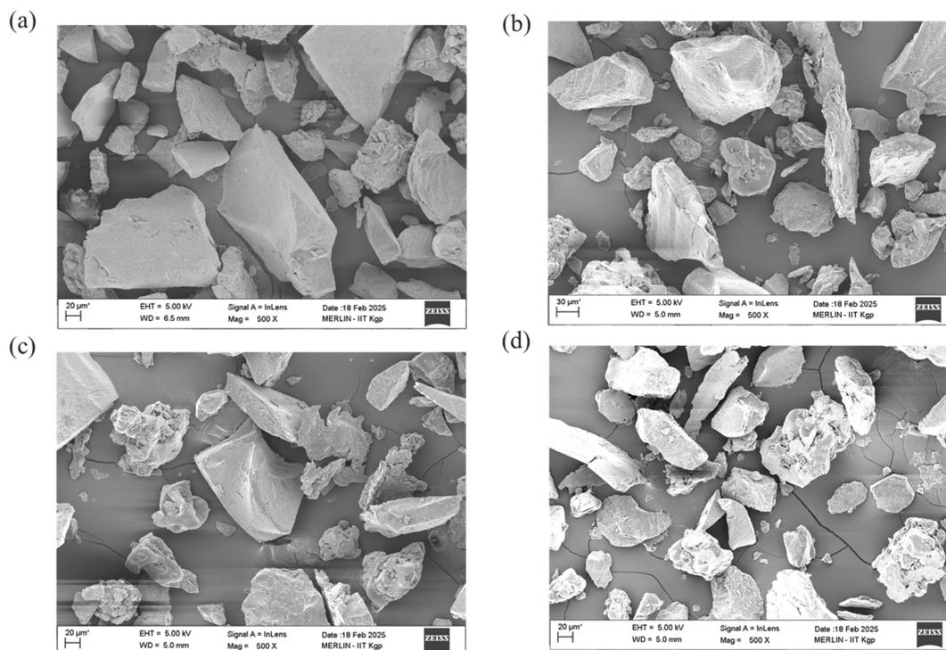
Fig. 4 SEM images of (a) PPI-NPs C, (b) PPI-NPs 30 kV 4 min, (c) PPI-NPs 30 kV 6 min and (d) PPI-NPs 30 kV 8 min.
