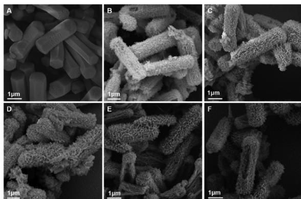
Fig. 1 SEM images of (A) MIL-68(In), (B) In<sub>2</sub>S<sub>3</sub>/ITO, (C) CdIn<sub>2</sub>S<sub>4</sub>@In<sub>2</sub>S<sub>3</sub>/ITO, (D) MIP/CdIn<sub>2</sub>S<sub>4</sub>@In<sub>2</sub>S<sub>3</sub>/ITO, (E) rMIP/CdIn<sub>2</sub>S<sub>4</sub>@In<sub>2</sub>S<sub>3</sub>/ITO and (F) NIP/CdIn<sub>2</sub>S<sub>4</sub>@In<sub>2</sub>S<sub>3</sub>/ITO.
