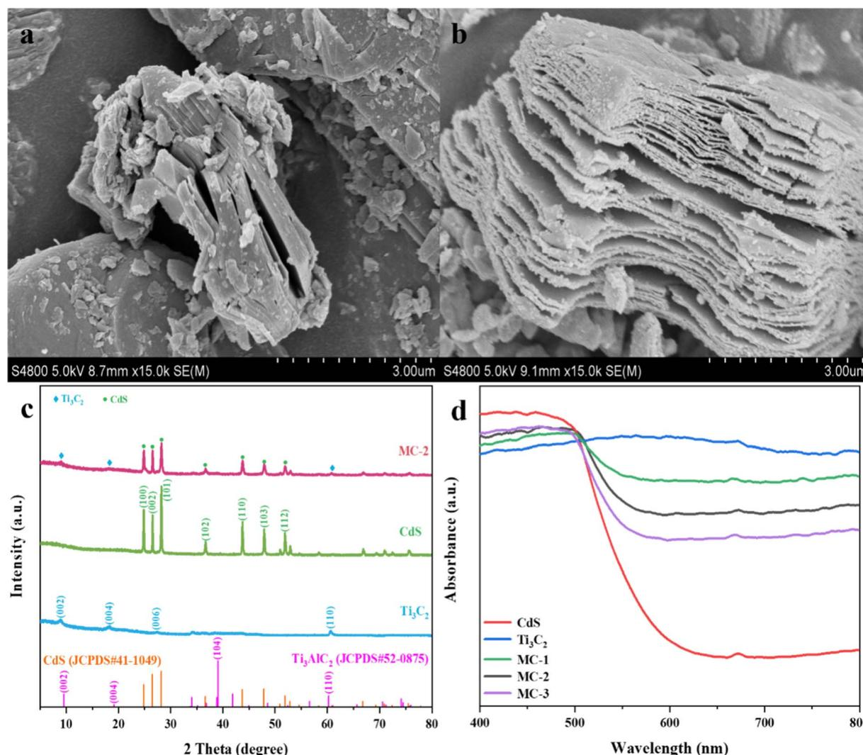
Fig. 2 SEM images of (a)  $\text{Ti}_3\text{AlC}_2$  and (b)  $\text{Ti}_3\text{C}_2$  MXene. (c) XRD spectra of  $\text{Ti}_3\text{C}_2$  and MC-2. (d) DRS spectra of  $\text{Ti}_3\text{C}_2$ , CdS, and MC composites.
