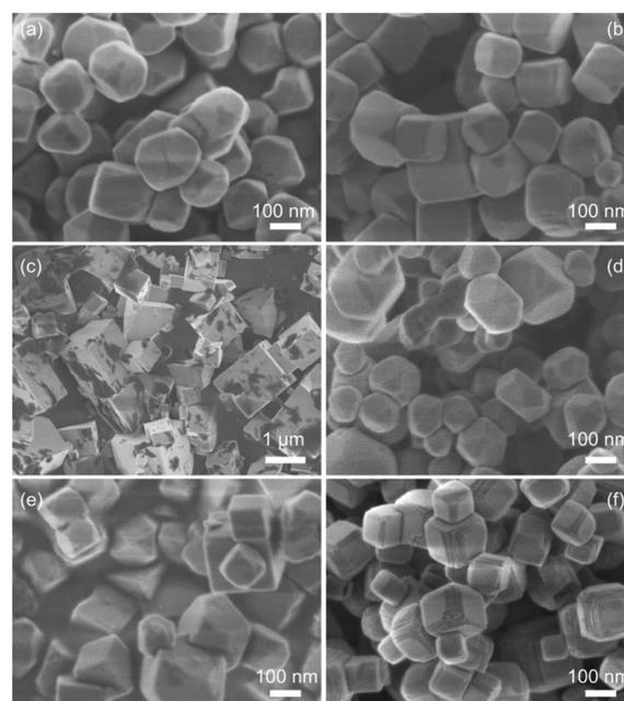
Fig. 1 SEM images of (a)  $\text{SrTiO}_3\text{:Al}$ , (b)  $\text{SrTiO}_3\text{:Sc}$ , (c)  $\text{SrTiO}_3\text{:Mg}$ , (d)  $\text{SrTiO}_3\text{:Al,Sc}$ , (e)  $\text{SrTiO}_3\text{:Al,Mg}$ , and (f)  $\text{SrTiO}_3\text{:Sc,Mg}$ .
