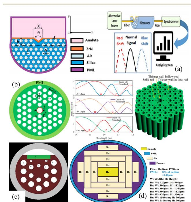
Fig. 20 Recently reported PCF biosensors for cancer detection: (a) M. Abdelghaffar *et al.*,<sup>98</sup> (b) Md. Aslam Mollah *et al.*,<sup>98</sup> (c) Mehdi fazeli *et al.*,<sup>99</sup> and (d) Mahmoud M. A. Eid *et al.*<sup>100</sup>
