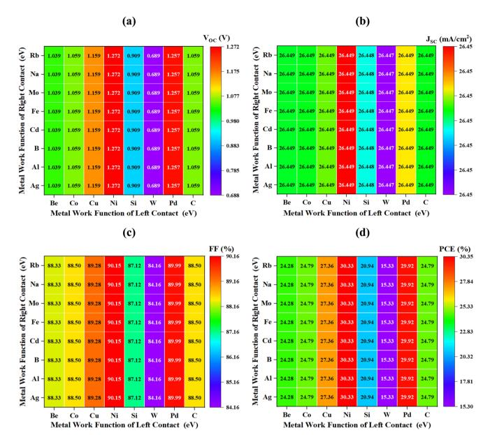
Fig. 2 Effect of metal in left touch for best Device-III (a)  $V_{\rm OC}$ , (b)  $J_{\rm SC}$ , (c) FF, and (d) PCE
