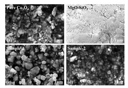
Fig. 2 Distinctive SEM images of (a) pure  $Co_3O_4$ , (b) bare  $MgO-SiO_2$ , (c)  $Co_3O_4/MgO-SiO_2$  composite (sample 1), and (d)  $Co_3O_4/MgO-SiO_2$  composite (sample 2).
