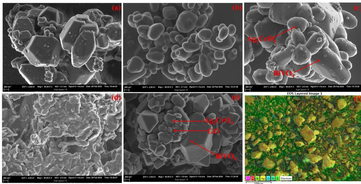
Fig. 2 SEM micrographs of (a)  $\text{BiVO}_4$ , (b)  $\text{Ag}_2\text{CrO}_4$ , (c)  $\text{BiVO}_4/\text{Ag}_2\text{CrO}_4$ , (d) GO, (e)  $\text{GO}/\text{BiVO}_4/\text{Ag}_2\text{CrO}_4$ , and (f) EDS mapping of  $\text{GO}/\text{BiVO}_4/\text{Ag}_2\text{CrO}_4$  nanocomposites.
