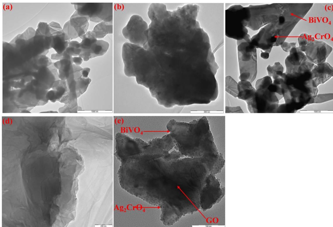
Fig. 4 TEM micrographs of (a)  $\text{BiVO}_4$ , (b)  $\text{Ag}_2\text{CrO}_4$ , (c)  $\text{BiVO}_4/\text{Ag}_2\text{CrO}_4$ , (d) GO and (e)  $\text{GO}/\text{BiVO}_4/\text{Ag}_2\text{CrO}_4$  nanocomposites.
