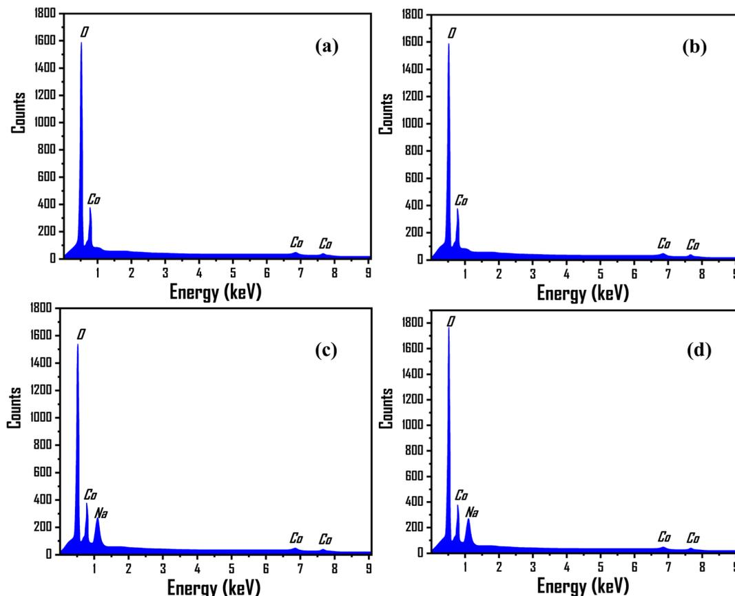
Fig. 5 EDX spectra for  $\text{Co}_3\text{O}_4$  thin films: (a) pure  $\text{Co}_3\text{O}_4$ , (b) 3% Li- $\text{Co}_3\text{O}_4$ , (c) 3% Na- $\text{Co}_3\text{O}_4$ , and (d) 3% Li, Na- $\text{Co}_3\text{O}_4$ .
