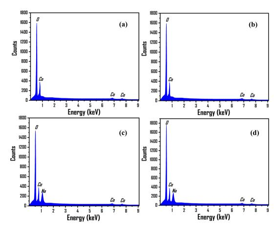
Fig. 5 EDX spectra for  $Co_3O_4$  thin films: (a) pure  $Co_3O_4$ , (b) 3% Li- $Co_3O_4$ , (c) 3% Na-  $Co_3O_4$ , and (d) 3% Li, Na- $Co_3O_4$ .
