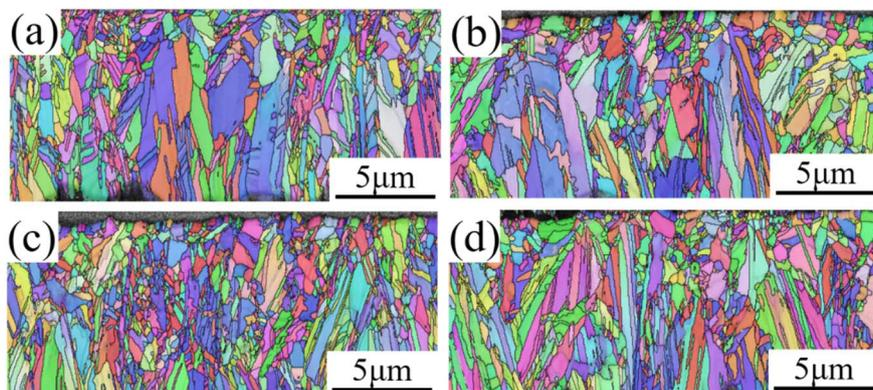
Fig. 8 Cross-sectional EBSD images of copper foils prepared with different PEG concentrations: (a)  $0 \text{ mg L}^{-1}$ ; (b)  $2 \text{ mg L}^{-1}$ ; (c)  $4 \text{ mg L}^{-1}$ ; (d)  $6 \text{ mg L}^{-1}$ .
