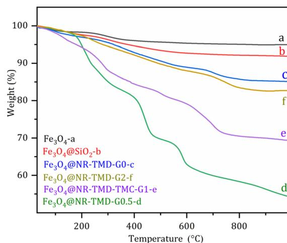
Fig. 3 TGA analysis of  $\text{Fe}_3\text{O}_4$  (a),  $\text{Fe}_3\text{O}_4\text{@SiO}_2$  (b),  $\text{Fe}_3\text{O}_4\text{@NR-TMD-G0}$  (c),  $\text{Fe}_3\text{O}_4\text{@NR-TMD-G0.5}$  (d),  $\text{Fe}_3\text{O}_4\text{@NR-TMD-G1}$  (e), and  $\text{Fe}_3\text{O}_4\text{@NR-TMD-G2}$  (f).
