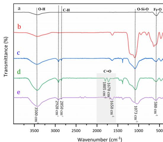
Fig. 1 FT-IR spectra of  $\text{Fe}_3\text{O}_4$  (a),  $\text{Fe}_3\text{O}_4\text{@SiO}_2$  (b),  $\text{Fe}_3\text{O}_4\text{@SiO}_2\text{-PrNH}_2$  (c), TMC (d), and  $\text{Fe}_3\text{O}_4\text{@NR-TMD-G1}$  (e).
