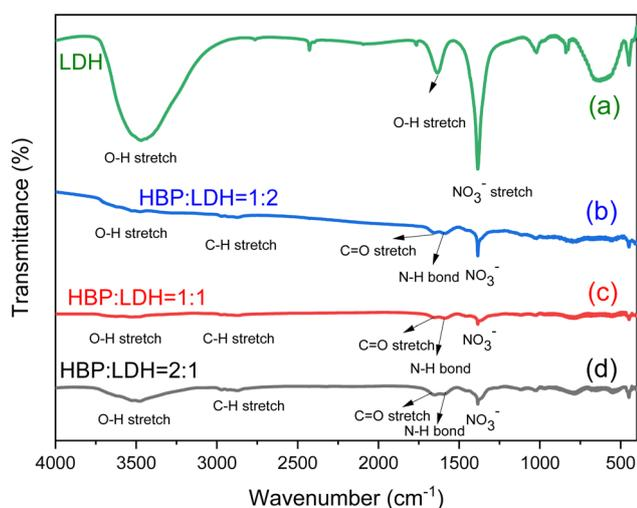
Fig. 3 FTIR spectra of (a) pristine LDHs and HBP/LDH = (b) 1/2, (c) 1/1, and (d) 2/1.
