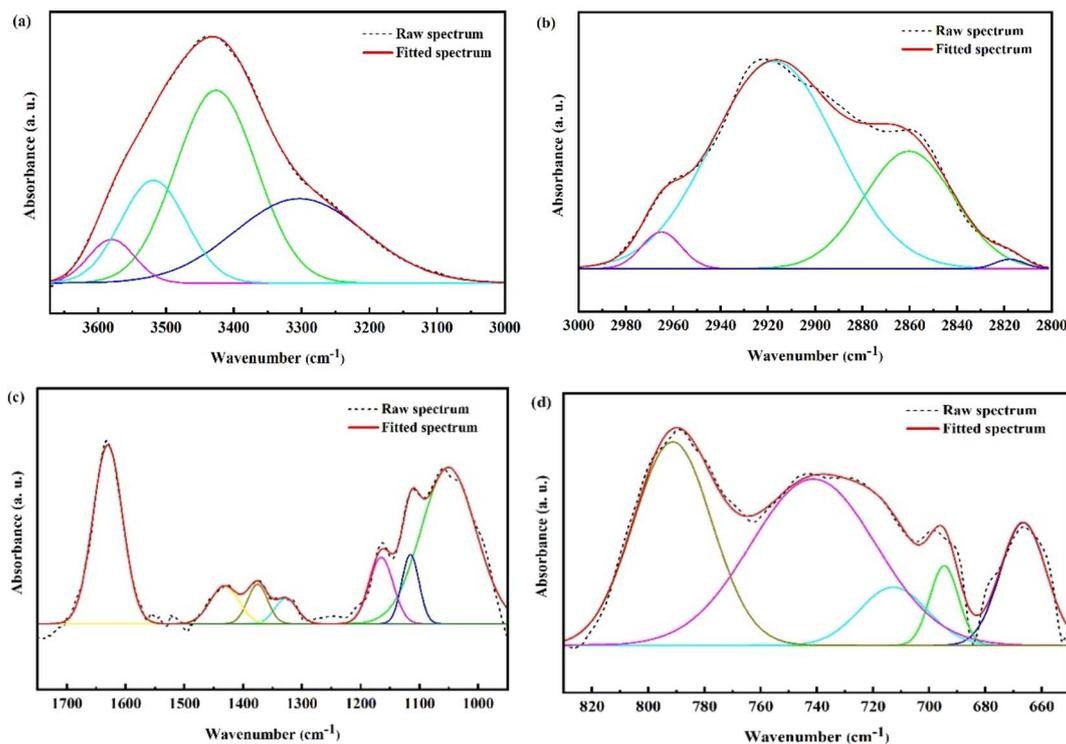
Fig. 9 Curve fittings of FTIR for the pyrolyzed coke of 10CS: (a)  $3600\text{--}3100\text{ cm}^{-1}$ , (b)  $3100\text{--}2800\text{ cm}^{-1}$ , (c)  $1700\text{--}950\text{ cm}^{-1}$ , (d)  $600\text{--}900\text{ cm}^{-1}$ .
