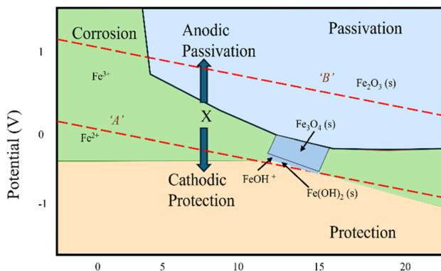
Fig. 3 Pourbaix diagram for steel.<sup>15</sup>
