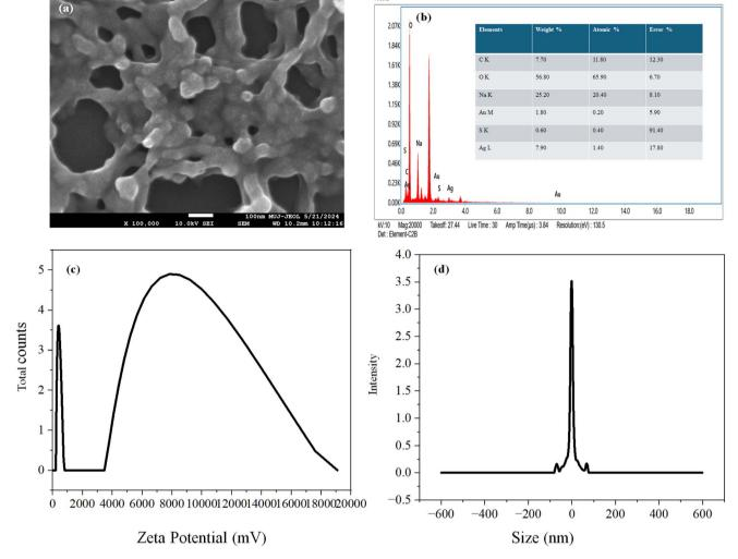
Fig. 4 (a) FESEM, (b) EDAX, (c) zeta potential, and (d) DLS spectra of NaAuAg@GSH.
