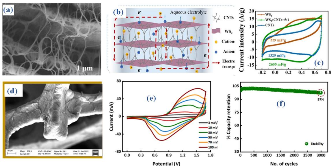
Fig. 8 The WS<sub>2</sub>@CNT thin-film (a) SEM (b) schematic structure (c) CV comparison<sup>55</sup> (d) magnetron sputtering MoWS<sub>2</sub> SEM (e) CV (f) stability performance.<sup>56</sup>
