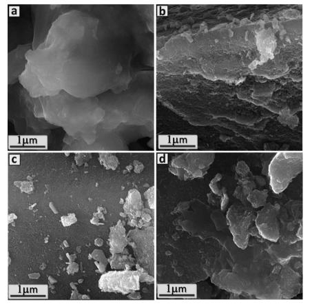
Fig. 3 FESEM images of (a) CuSe (b) TiO<sub>2</sub> (c) AK-1 (d) AK-4.
