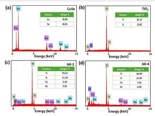
Fig. 4 EDX spectra of (a) CuSe (b) TiO<sub>2</sub> (c) AK-1 (d) AK-4.
