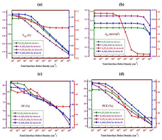
Fig. 10 The impact of interface defect densities on the outputs of the PSC: (a)  $V_{\rm OC}$  (b)  $J_{\rm SC}$  (c) FF and (d) PCE.
