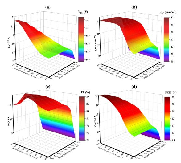
Fig. 8 Influence of active layer defect density on electrical properties of PSCs: (a)  $V_{\rm OC}$  (b)  $J_{\rm SC}$  (c) FF and (d) PCE.
