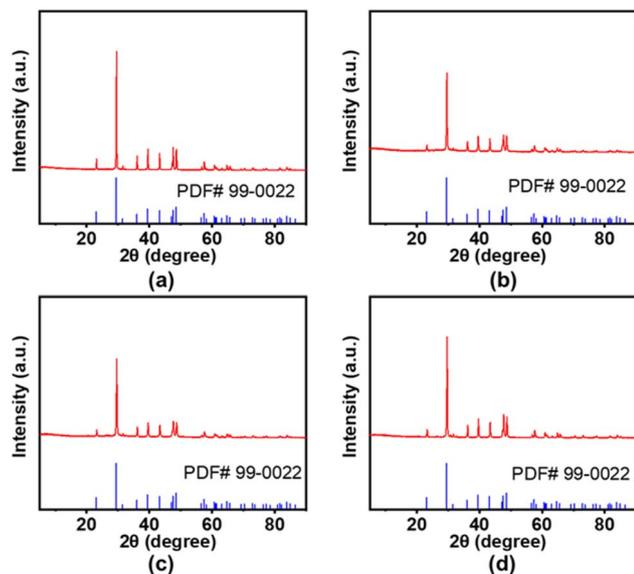
Fig. 11 XRD plots of calcium alginate fiber residual charcoal at different densities: (a)  $40 \text{ kg m}^{-3}$ ; (b)  $60 \text{ kg m}^{-3}$ ; (c)  $80 \text{ kg m}^{-3}$ ; (d)  $100 \text{ kg m}^{-3}$ .
