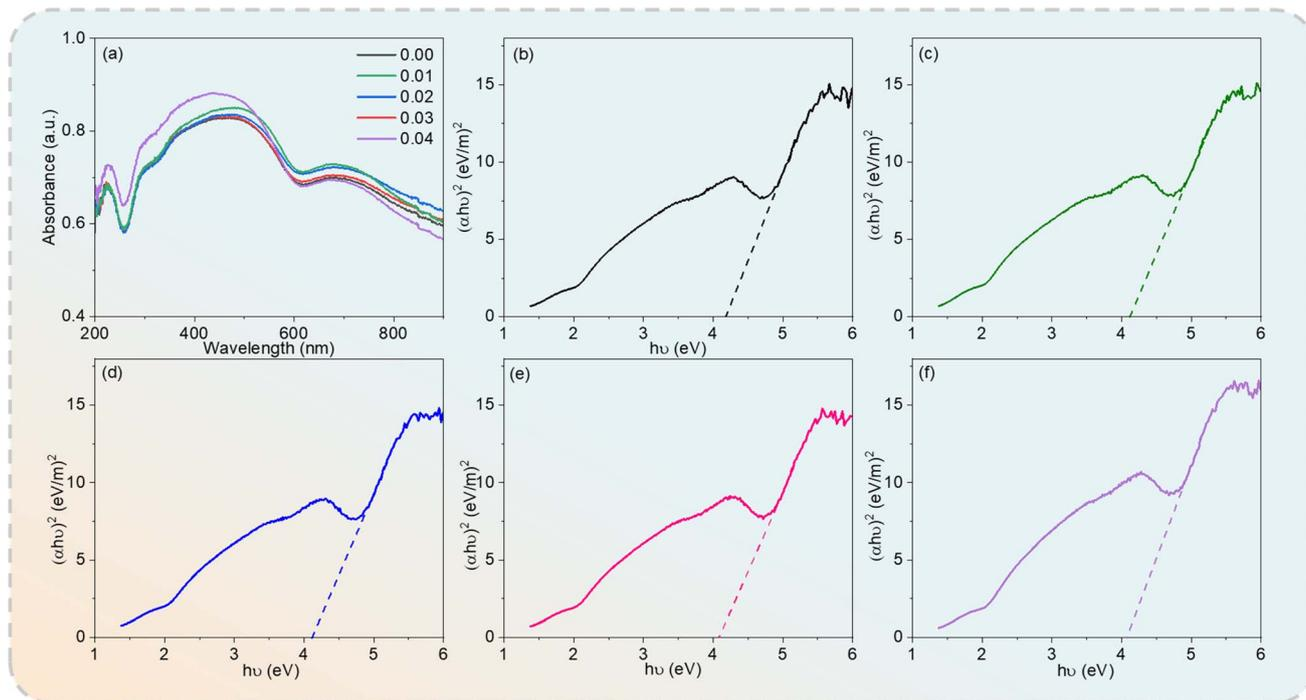
Fig. 6 (a) UV-vis absorption spectra of  $\text{Cd}_{1-x}\text{Na}_x\text{Cu}_3\text{Ti}_4\text{O}_{12}$  ceramics and  $(\alpha h\nu)^2$  versus  $h\nu$  plots at (b)  $x = 0.0$ ; (c)  $x = 0.02$ ; (d)  $x = 0.04$ ; (e)  $x = 0.06$ ; (f)  $x = 0.08$ .
