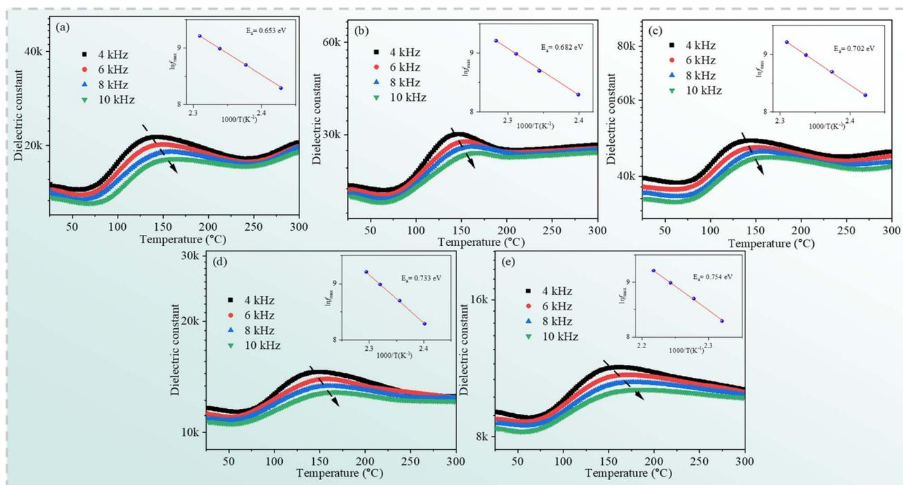
Fig. 10 Temperature dependence of the dielectric constant for the  $\text{Cd}_{1-x}\text{Na}_x\text{Cu}_3\text{Ti}_4\text{O}_{12}$  ceramics (a)  $x = 0.0$ ; (b)  $x = 0.02$ ; (c)  $x = 0.04$ ; (d)  $x = 0.06$ ; (e)  $x = 0.08$ .
