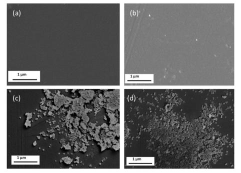
Fig. 3 SEM micrographs for dense PSF/ZIF-8 mixed matrix membranes (a) DZ0.75 (b) DZ1 (c) DZ2 (d) DZ5.
