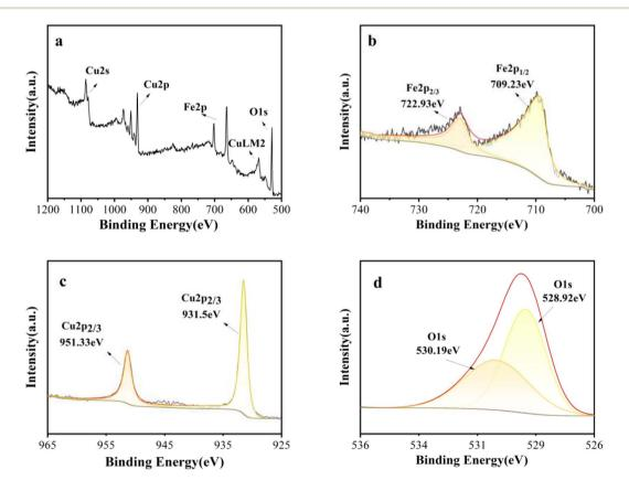
Fig. 2 (a) XPS patterns of  $Cu_2O@Fe_3O_4$  survey, (b) Fe2p, (c) Cu2p, (d) O1s
