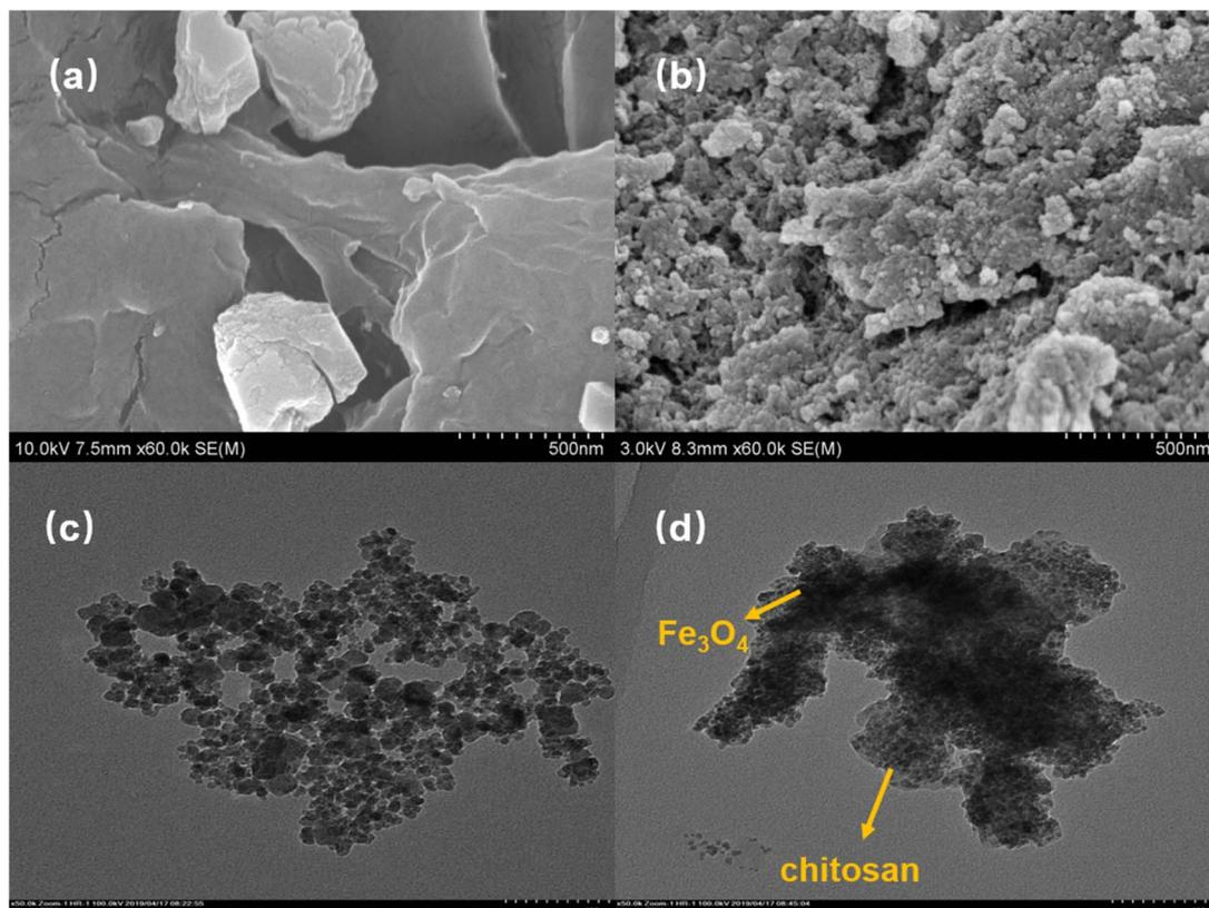
Fig. 1 (a) SEM images of chitosan and (b) EMMCS-G. (c) TEM images of Fe<sub>3</sub>O<sub>4</sub> and (d) EMMCS-G.
