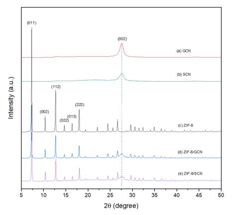
Fig. 1 XRD patterns of synthesized (a) GCN, (b) SCN, (c) ZIF-8, (d) ZIF-8/GCN, and (e) ZIF-8/SCN
