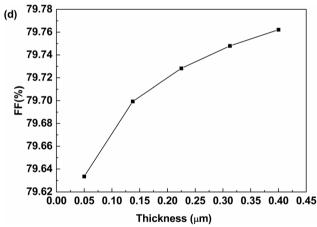
Fig. 12 Impact of thickness variation in n-type layer on output parameters (a) PCE (b)  $V_{\rm OC}$  (c) current density (d) FF.
