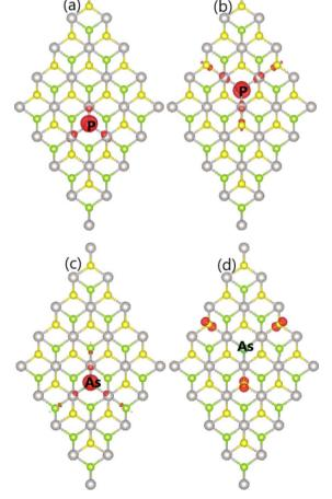
Fig. 10 Spin density (iso-surface value: 0.005 e Å $^{-3}$ ) in (a)  $P_S$ , (b)  $P_{Se}$ , (c)  $As_S$ , and (d)  $As_{Se}$  system.
