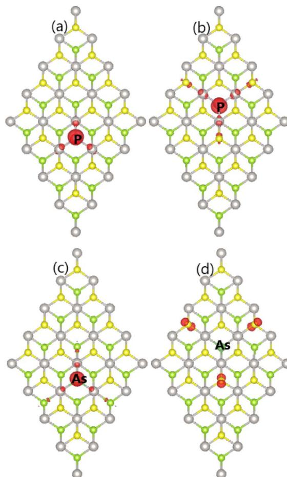
Fig. 10 Spin density (iso-surface value:  $0.005 \text{ e} \text{ \AA}^{-3}$ ) in (a)  $\text{P}_{\text{S}}$ , (b)  $\text{P}_{\text{Se}}$ , (c)  $\text{As}_{\text{S}}$ , and (d)  $\text{As}_{\text{Se}}$  system.
