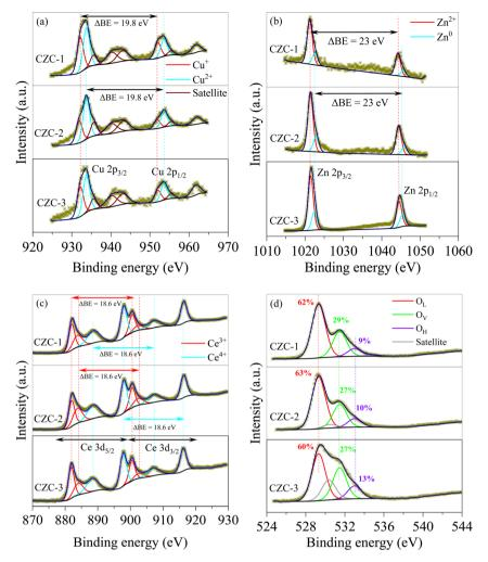
XPS spectra of CZC catalysts (a) Cu 2p, (b) Zn 2p, (c) Ce 3d, and (d) O 1s.
